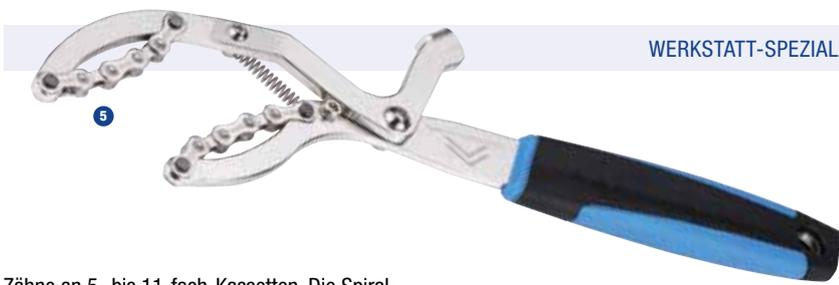
Zähne an 5- bis 11-fach-Kassetten. Die Spiralfeder drückt die Kettenglieder der Backen auf die Ritzel und verhindert ein Abrutschen.
